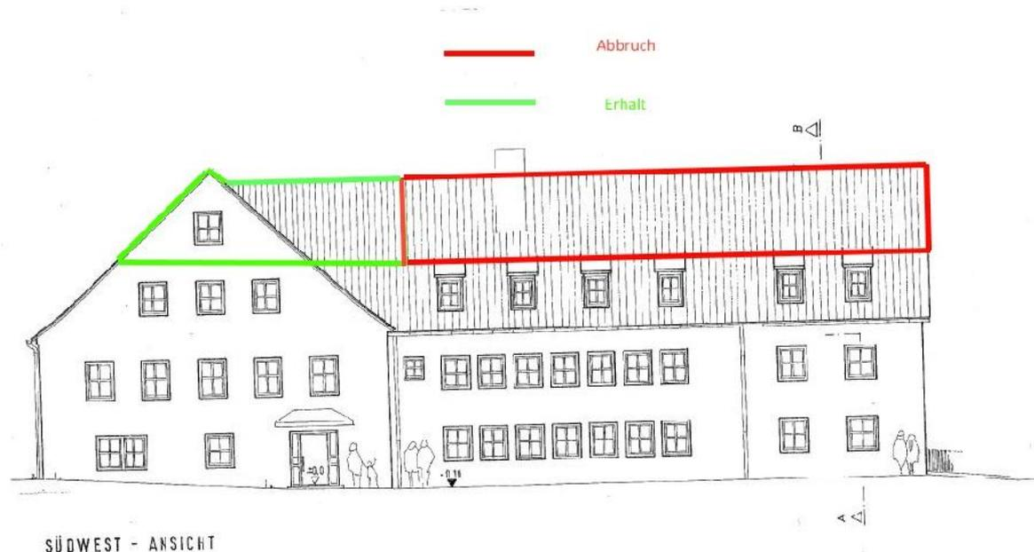
**Abbildung 4:** Dachstuhlbereich der ehemaligen Waldbauernschule. Rot markiert der nutzungsfreie und nicht ausgebaute Dachstuhl des südöstlichen Abrissgebäudes. Im Nordwestlichen Gebäudeteil befindet sich ebenfalls noch ein kleiner Bereich nicht genutzten und nicht ausgebauten Dachstuhls. Dieser ist grün markiert. Es handelt sich um ein Nebendach. Der Rest des Dachstuhls ist als Saal ausgebaut. Kartenmaterial: Gemeinde Scheyern
