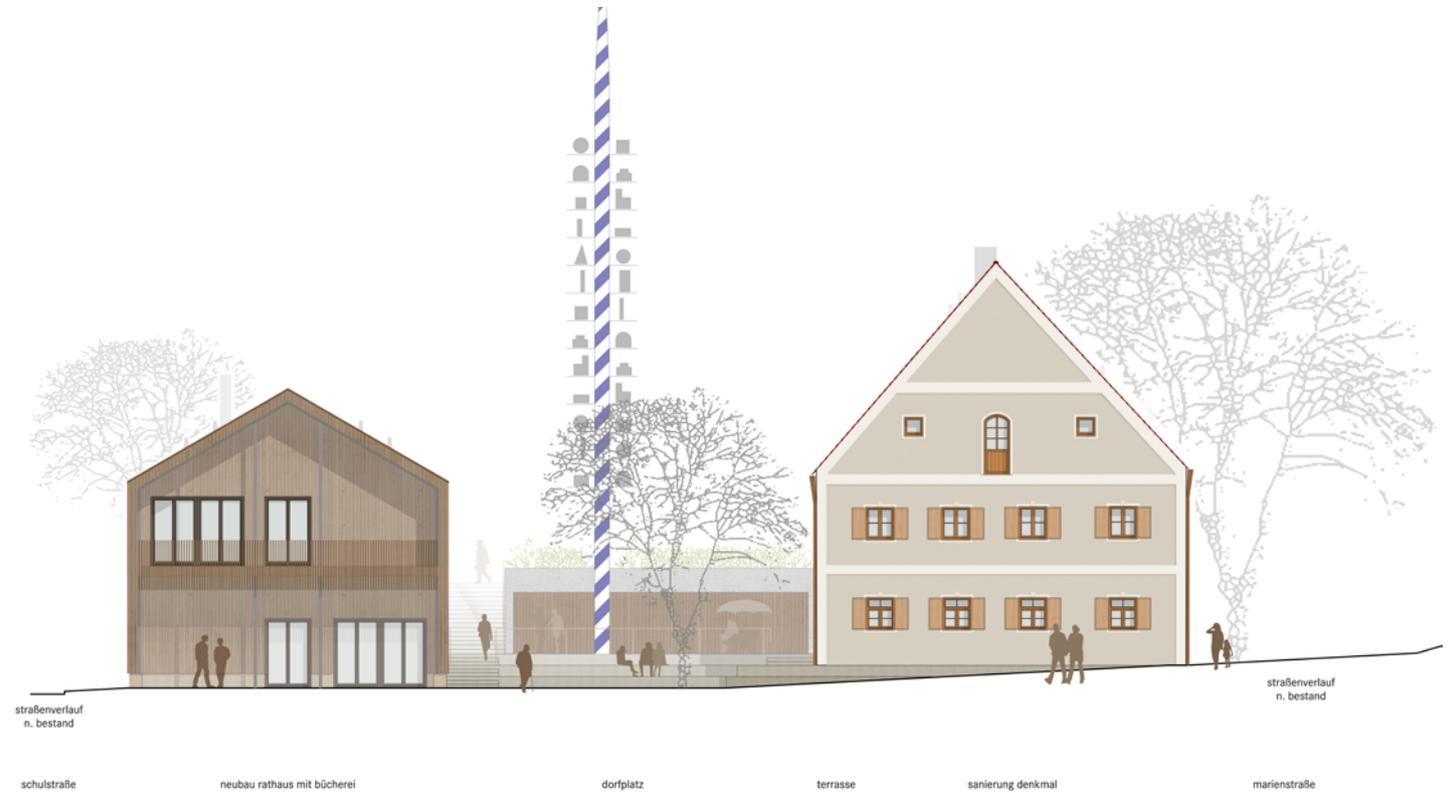
**Neubau** – Bedachung Kupfer, Holzfassade (imprägniertes heimisches Kiefernholz)
